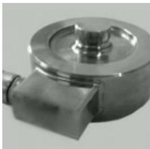
Le celle di carico a compressione serie **M/A PR3 VIS** consentono di visualizzare direttamente sulla cella di carico il valore del carico applicato. Oltre alla visualizzazione del peso sono possibili funzioni quali: funzione di picco, impostazione di filtri, e calibrazione mediante linearizzazione di più punti di carico.
